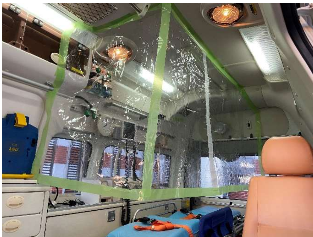
図5-7 間仕切りカーテン設置
