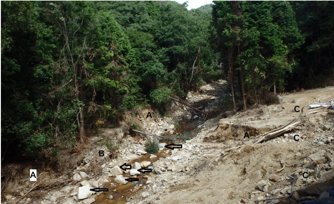
図14 a地点：ゆるやかな溪床の中流部 数10cm～1m程度の巨礫が散在（矢印） A：過去の土石流堆積物 B：石垣 C：図12のdの谷からの土石流堆積物
