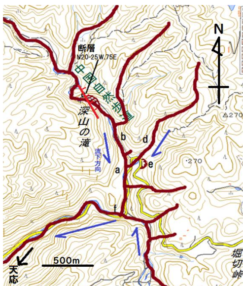
図 21 深山の滝付近の土砂災害と断層との関係 国土地理院 HP 3) に加筆
