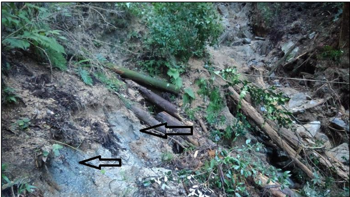
図 8-2. C 地点左岸に見られる青灰色の粘土質の土砂層(矢印)。
